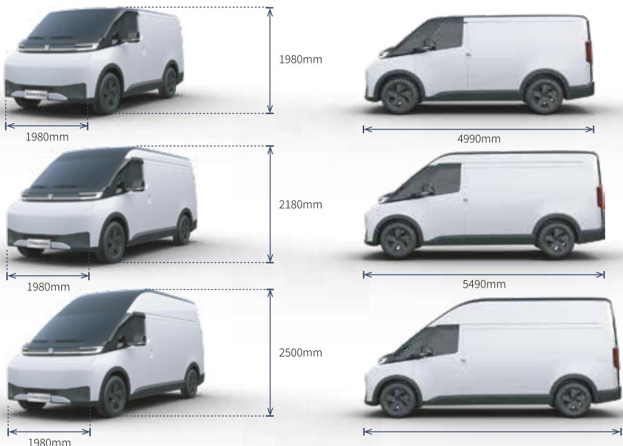
Farizonova GMA drive-by-wire arhitektura omogućava vozilu razne mogućnosti prilagođavanja. Sa teretnim prostorom od 7,6 m<sup>3</sup> do 12,6 m<sup>3</sup>, SuperVAN može zadovoljiti potrebe urbane logistike globalnog tržišta.
